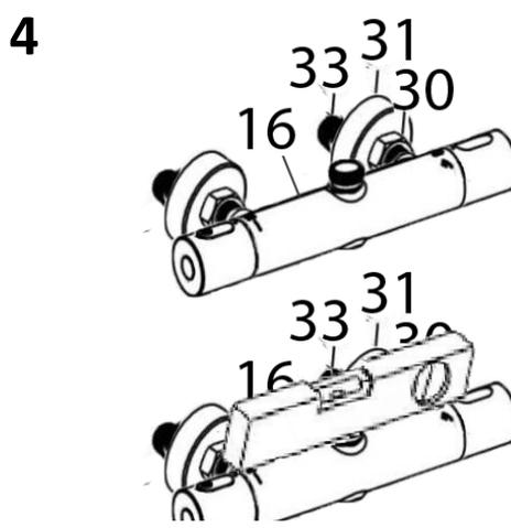
Remonter ensuite le mitigeur (16), sans oublier d'y insérer les filtres-joints (32), en serrant normalement les écrous (31), et sans perturber les raccords excentriques (33). Vérifier de nouveau l'horizontalité de votre mitigeur (16).
