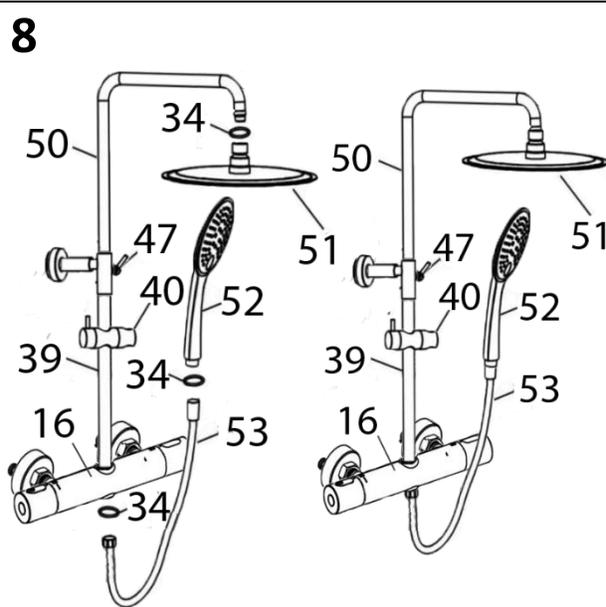
Visser la tête de douche (51) au tube de structure partie haute (50) en y interposant un joint d'étanchéité (34). Visser la douchette (52) au flexible en y interposant un joint d'étanchéité (34), puis visser le flexible (53) au mitigeur (16) en y interposant un joint d'étanchéité (34). Ouvrir l'arrivée d'eau, vérifier l'absence de fuite. Nettoyer le produit avec un chiffon humide.
