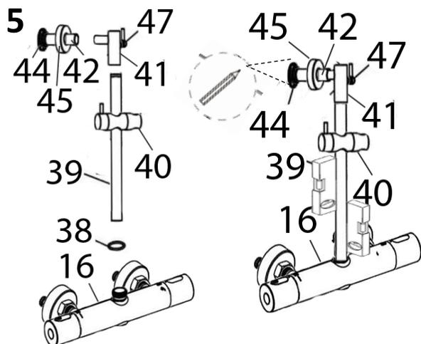
Insérer le tube de structure partie basse (39) dans le connecteur en T (41), puis insérer ce dernier (41) dans le système de fixation (42&44). Positionner ensuite l'ensemble au niveau du mitigeur (16) en y interposant le joint d'étanchéité (38). Ajuster le tube (39) pour qu'il ait une position verticale. Marquer les points au mur qui serviront de fixation au niveau du cadre de fixation (44).
