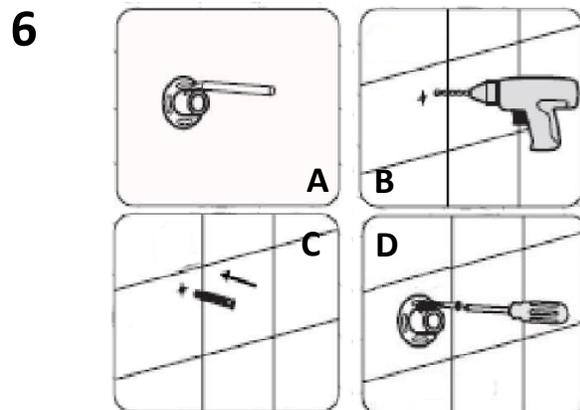
Retirer le tube de structure (39) du mitigeur. Au niveau des marquages effectués à l'étape précédente, vérifier la non présence de câbles ou tuyaux derrière le mur puis percer ce dernier (B). Dans le cas de carrelage au mur, privilégier une fixation dans le joint, sinon utiliser un foret pour carrelage, percer lentement et sans percussion. Insérer les chevilles (C), positionner le système de fixation (44), puis insérer des vis jusqu'à stabilité de l'ensemble (D).
