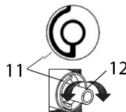
Tourner le cylindre interne (12) SANS modifier l'angle du régulateur (demi cylindre 11), tout en continuant de relever la température de l'eau de sortie, jusqu'à obtenir pour cette dernière la température souhaitée (38°C en général).
