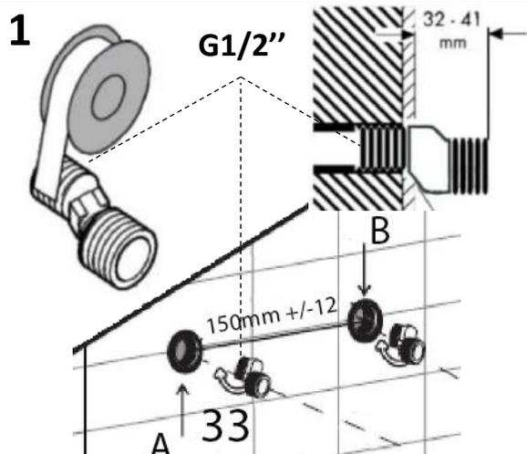
Une fois la position de fixation du robinet bien définie, préparer les tuyaux d'arrivées d'eau chaude (A) et d'eau froide (B) avec en extrémité des prises femelles 1/2".
