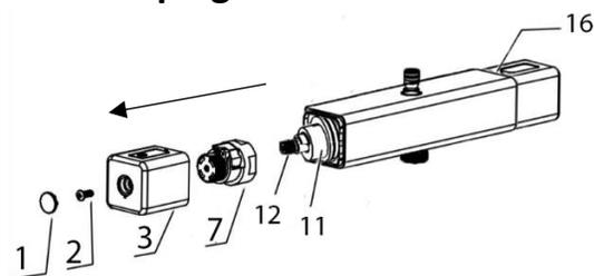
Tourner la poignée de contrôle de température (3) au niveau de la position de blocage. Retirer le cache-poignée (1), puis desserrer la vis (2). Retirer la poignée (3) et le cache-cartouche (7).
