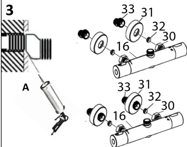
Couper l'eau, puis purger votre mitigeur en ouvrant ce dernier. Retirer le mitigeur (16). Placer du joint silicone (A) autour des arrivées d'eau, entre ces dernières et le mur, pour éviter que l'eau ne puisse y pénétrer.
