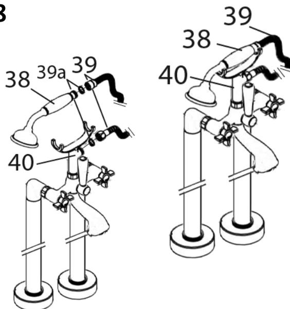
Visser le flexible de douchette (39) au mélangeur (40). Visser ensuite la douchette (38) au flexible (39). Prenez garde qu'un joint d'étanchéité (39a) soit bien présent à chaque extrémité du flexible (39) pour assurer l'étanchéité du système.
