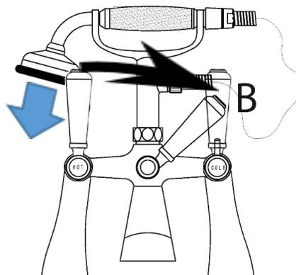
Lorsque la poignée centrale du corps du mélangeur est en position B, ce dernier fonctionne avec la sortie au niveau de la douche.
