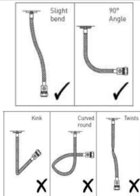
Vérifier que les flexibles de raccordement ne soient pas pincés, pliés ou tordus.
