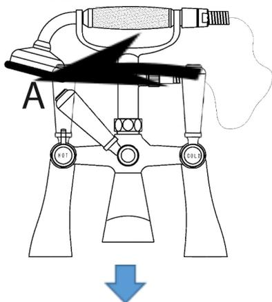
Lorsque la poignée centrale du corps du mélangeur est en position A, ce dernier fonctionne avec la sortie d'eau au niveau du bec verseur.
