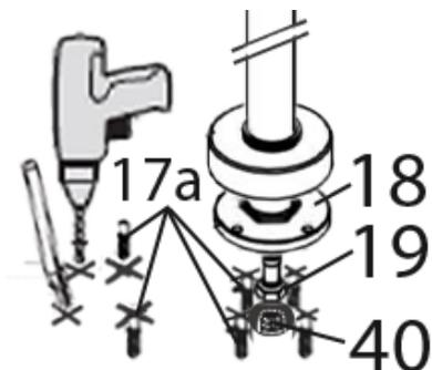
Dans le cas d'un sol béton : retirer le système de sa position, percer les trous au sol au niveau des points marqués précédemment, insérer des chevilles de fixation (17a), puis raccorder les flexibles (19) aux arrivées d'eau (40).
