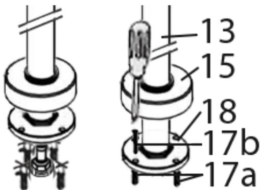
Refermer les arrivées d'eau, positionner le système, les trous des plaques de fixation (18) alignés avec les chevilles de fixation au sol (17a), puis insérer dans chaque cheville (17a) une vis (17b), jusqu'à stabilisation de l'ensemble.
