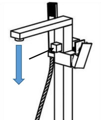
Lorsque le bouton au-dessus de la poignée est poussé, enfoncé, le mitigeur fonctionne avec la sortie d'eau au niveau du bec du robinet.
