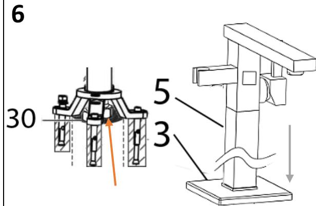
Raccorder les flexibles (30) aux alimentations en eau chaude et froide en accord avec le schéma page 4.
