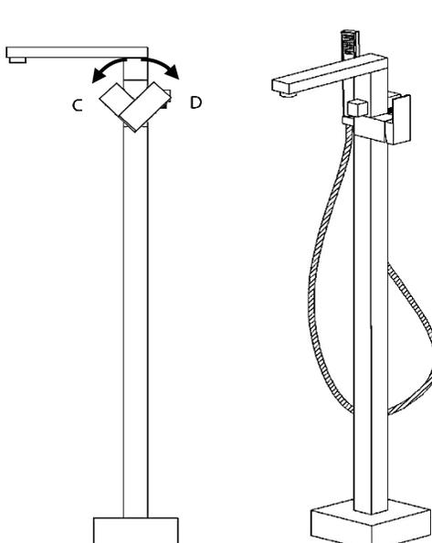
Tourner dans le sens des aiguilles d'une montre jusqu'en butée (position C) augmente la température de l'eau de sortie.
