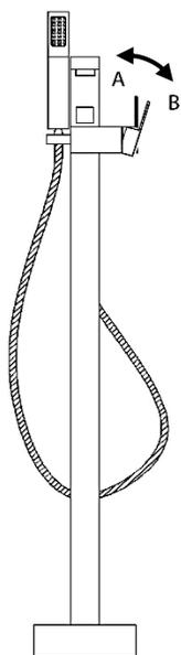
La position A représente la position fermée du robinet (le débit de sortie est nul). Tirer la poignée vers le bas ouvre le robinet de façon progressive. La poignée arrive en butée en position B, ce qui correspond au débit maximal du mitigeur.
