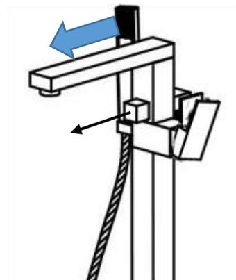
Lorsque le bouton au-dessus de la poignée est tiré, le mitigeur fonctionne avec la sortie au niveau de la douchette.
