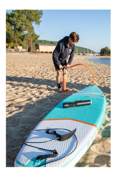
Avant chaque session, inspecte attentivement ton embarcation et ton Kahe POD pour vérifier que tout est en état de fonctionnement. L'ogive avant du Kahe POD doit être parfaitement verrouillée. Les grilles de protection en amont et en aval de l'hélice doivent être présentes. Rien de doit empêcher l'hélice de tourner. Vérifie que ta batterie est bien chargée et attache ton leash avant de t'élancer...
