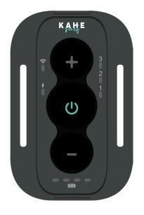
La télécommande te permet de piloter ton Kahe POD. Grâce à elle, lorsque tu es sur l'eau, tu peux choisir ta vitesse et suivre l'état de charge de la batterie.
