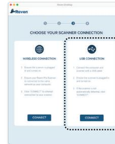
**1.3** Seleccione el método de conexión USB a su escáner y utilice el cable USB incluido en la caja para conectar el escáner a la computadora.
