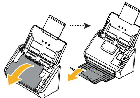
**2.3** Baje la bandeja de salida y levante el tope para evitar que el papel se caiga.
