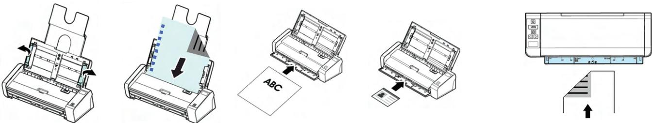
**5.1** Para usar el Alimentador Automático extienda por completo las dos secciones de la bandeja y levante la guía de papel para sujetar sus documentos. Coloque sus documentos hacia abajo y la parte superior de las páginas en dirección al alimentador. Verifique que las guías sujetadoras del papel estén alineadas con el borde de los documentos.
