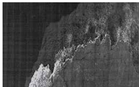
Foto van een elektronenmicroscopie scan. Witte oppervlakken: latente hydraulische componenten die de poriënstructuur van de ondergrond zijn binnengedrongen poriën verstoppen door kristalvorming.
