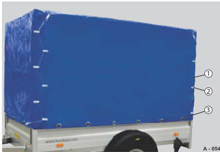
Abb. 61 Sicherung mit Schleuderseil / Krampen
