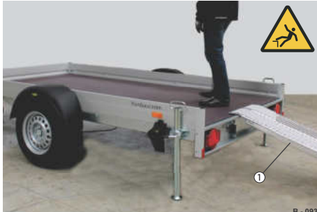
Abb. 31 Ladefläche über Auffahrhilfen betreten
