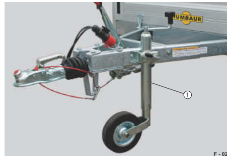
Abb. 2 Stützrad Manuell, zum Hochstellen
