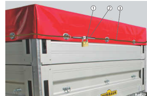
Abb. 60 Zollseilsicherung als Diebstahlschutz
