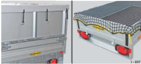
Abb. 47 Flachplane auf Aufbauten / Abdecknetz
