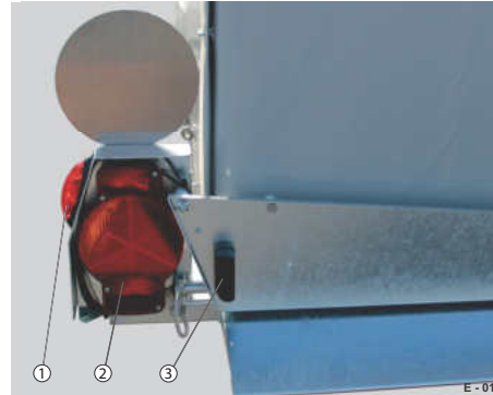
Abb. 17 Multifunktionsleuchte senkrecht, links
