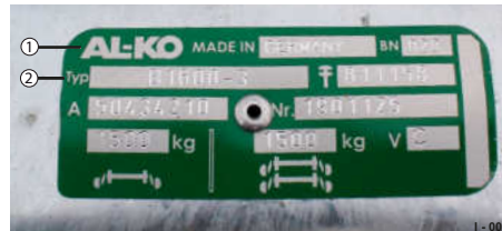
Abb. 25 Beispiel: Typenschild AL-KO-Achse, gebremst
