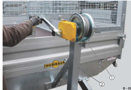
Abb. 40 Variante 2: Seilwinde, mittig fest
