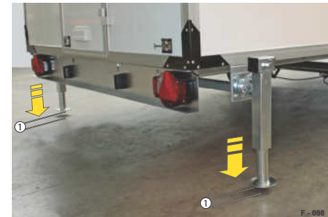
Abb. 20 Abstützung zum Beladen
