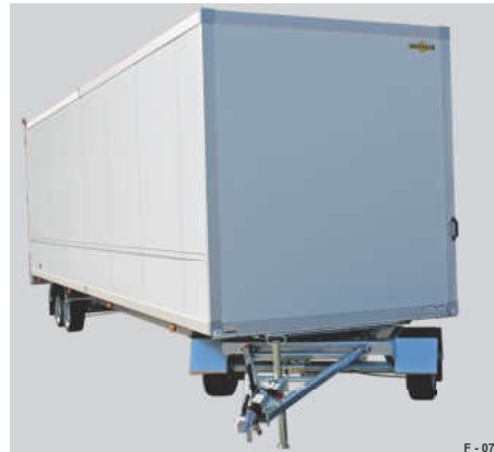
Abb. 58 Beispiel: 3-Achser als Kofferaufbau, Sandwich
