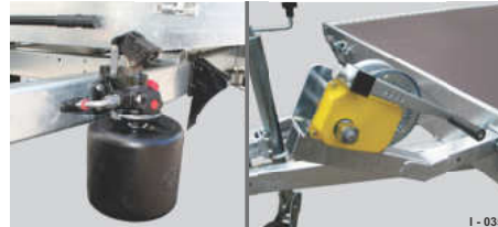
Abb. 44 Hydraulikanlage / Seilwinde manuell, elektrisch
