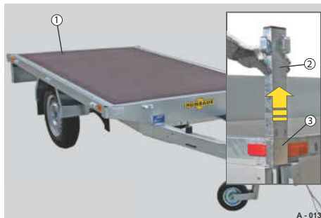
Abb. 14 Bordwände demontiert, Eckrungen ausgesteckt
