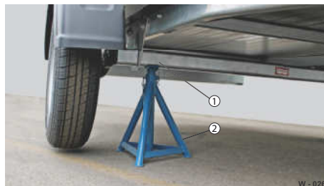
Abb. 29 Anhänger aufbocken / abstützen
