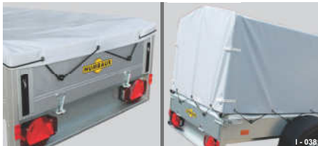
Abb. 48 Flachplane / Hochplane mit Spiegel
