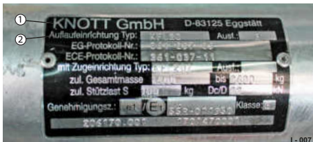
Abb. 23 Beispiel: Blechschild, Auflaufeinrichtung
