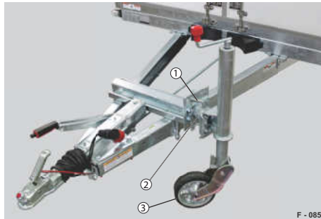
Abb. 5 Beispiel: Automatik-Stützrad, schwenkbar
