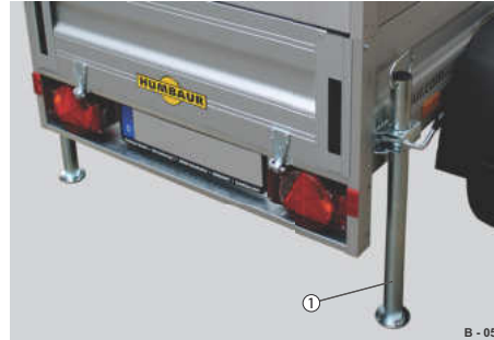
Abb. 76 Anhänger mit Stützen, gesichert
