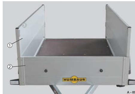
Abb. 26 Heckbordwand / Bordwandaufsatz, demontiert
