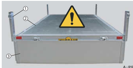
Abb. 2 Ungesicherte Bordwände / Eckrungen
