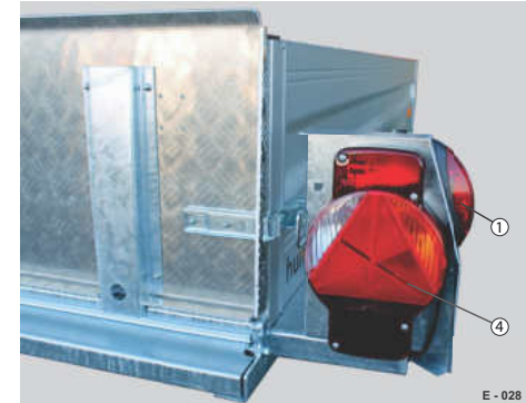
Abb. 18 Multifunktionsleuchte senkrecht, rechts
