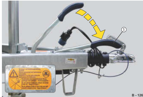
Abb. 86 Beispiel 2: Handbremse gelöst, BPW
