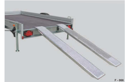
Abb. 69 Beispiel 3: Auffahrampen, Stahl
