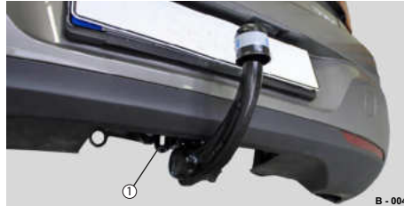
Abb. 3 Beispiel 3, abnehmbare Kupplung, Öse am Träger
