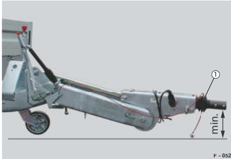
Abb. 49 HV-Deichsel, Minimale Höhe
