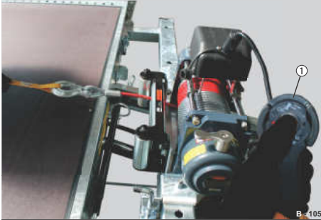
Abb. 46 Beispiel 2: Seilwinde mit Fernbedienung
