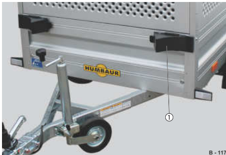
Abb. 80 Beispiel 4: Unterlegkeile stirnseitig, nachgerüstet
