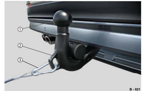
Abb. 21 Beispiel: Abreißseil, Karabinerhaken befestigt
