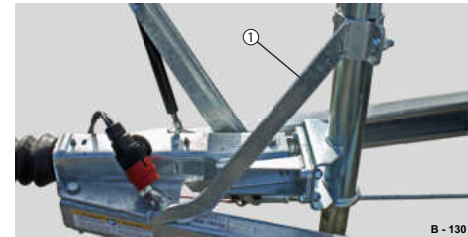
Abb. 14 Verstärkung Stützrad, optional
