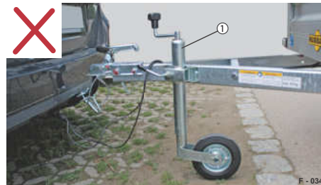
Abb. 7 Stützrad, Stützstellung falsch
