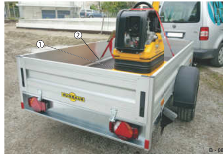
Abb. 66 Beispiel: Ladungssicherung, festes Ladegut
