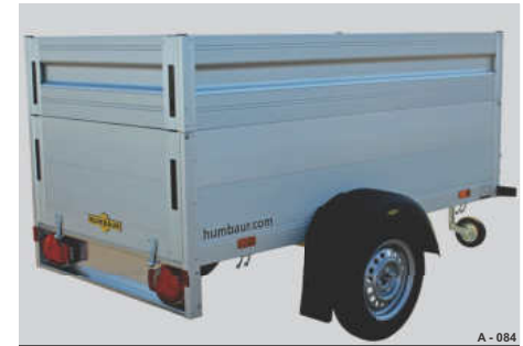
Abb. 23 Bordwandaufsatz, z.B. bei HA 500
