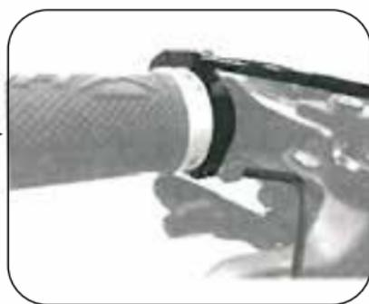
11. Utilizzare chiave da 3 mm per fissare la leva del morsetto sul manubrio.
