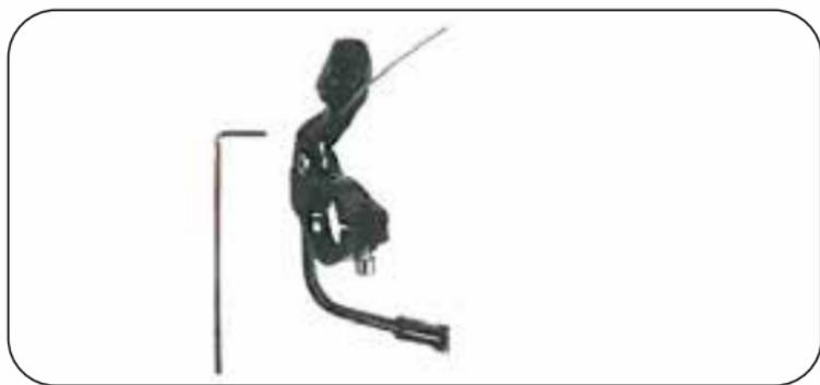
7. Tirare il cavo fino e fissare la vite con chiave da 2 mm.
