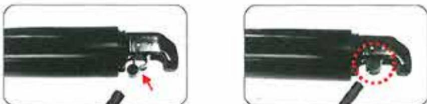
4 Fissare il fermacavo sull'asta di trazione, come mostrato sopra
