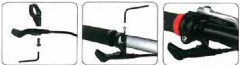
Installare la leva solo sul lato sinistro del manubrio. Utilizzare chiave a brugola da 3 mm per fissare la leva sul manubrio.
