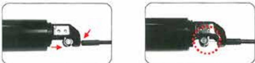
5 Tirare e inserire il cavo attraverso la fessura, fissare l'alloggiamento del cavo sulla parte inferiore della rientranza
