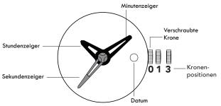
Wenn Ihre Uhr über eine verschraubte Krone verfügt, lösen Sie die verschraubte Position.
