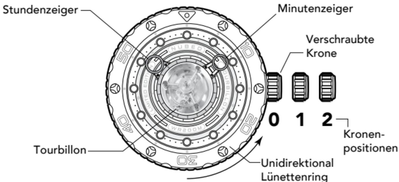
Wie Ihre Uhr über eine verschraubte Krone verfügt, lösen Sie die verschraubte Position.
