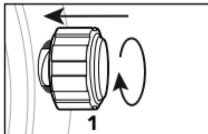
**Zum Verschrauben.:** Drücken Sie die Krone ganz hinein (in Richtung der Uhr) und drehen sie dann im Uhrzeigersinn, bis sie fest verschraubt ist.
