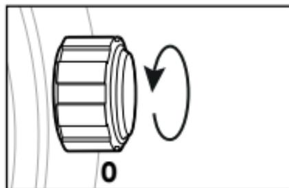
**Zum Lösen:** Drehen Sie die Krone gegen den Uhrzeigersinn, bis sie sich ohne Spannung frei dreht. Ziehen Sie die Krone zur Einstellung der Uhr vorsichtig in die anderen gewünschten Positionen heraus (siehe spezielle Bedienungsanleitung auf den folgenden Seiten).
