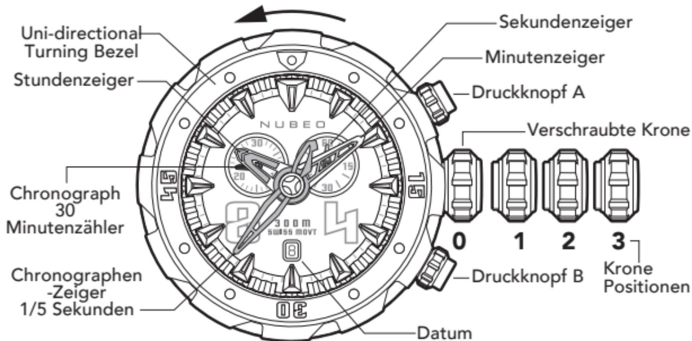
Wie Ihre Uhr über eine verschraubte Krone verfügt, lösen Sie die verschraubte Position.
