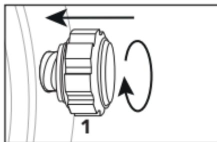
**Zum Verschrauben.:** Drücken Sie die Krone ganz hinein (in Richtung der Uhr) und drehen sie dann im Uhrzeigersinn, bis sie fest verschraubt ist.
