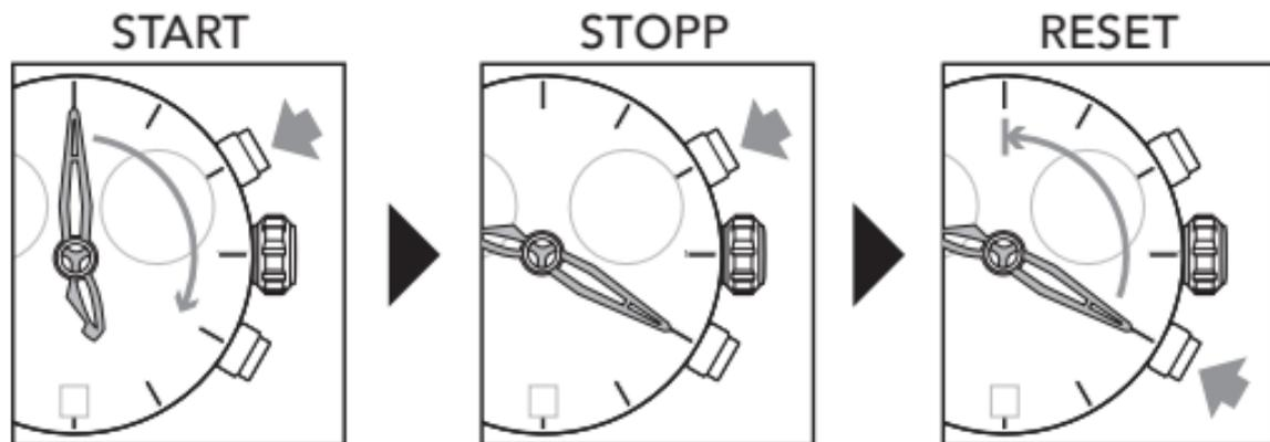
Nach 2 Laufstunden stoppt der Chrono und geht automatisch auf die Nullstellung zurück, um die Batteriestrom zu sparen.
