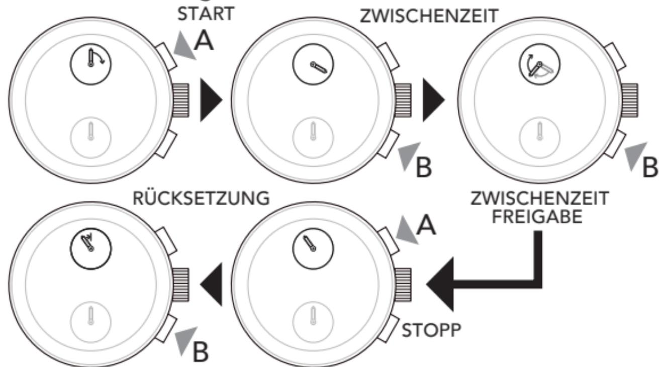
\* Zwischenzeitmessung und Freigabe der Zwischenzeitanzeige können beliebig oft ausgeführt werden, indem Sie wiederholt Taste B betätigen.
