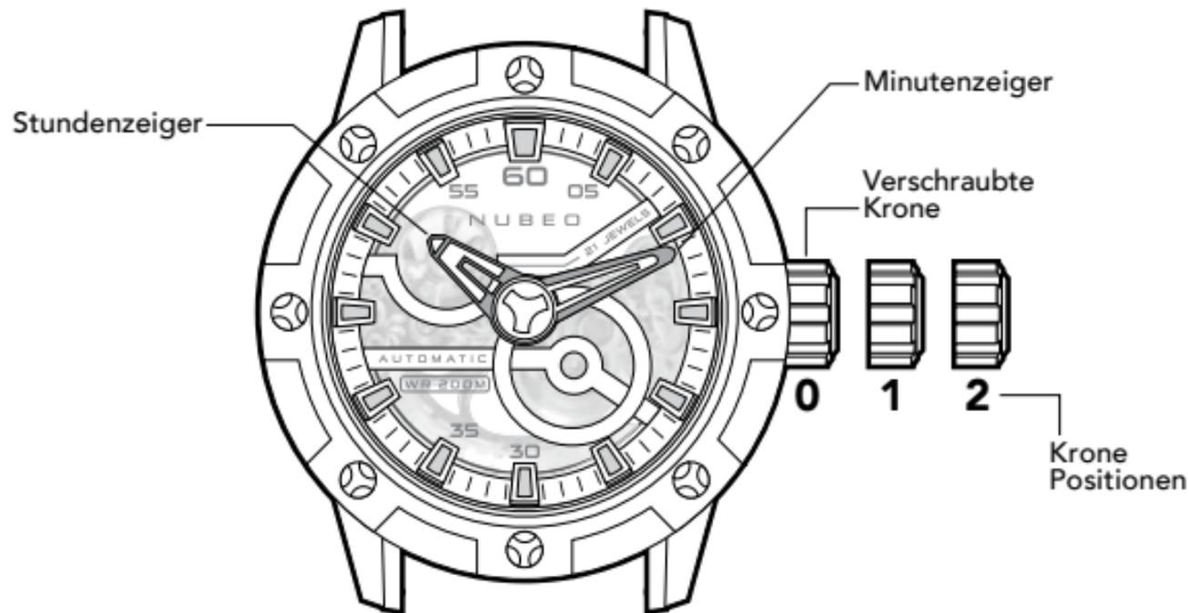
Wie Ihre Uhr über eine verschraubte Krone verfügt, lösen Sie die verschraubte Position.
