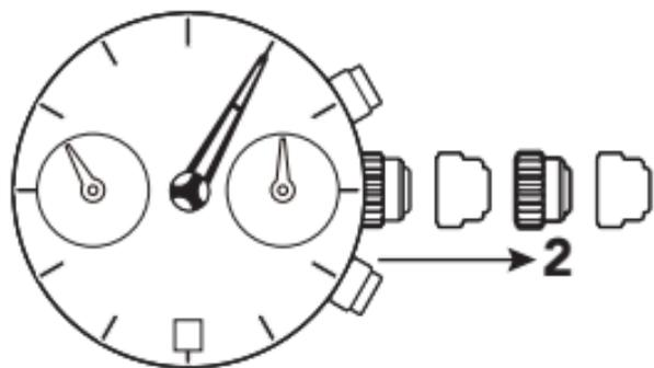
2. Drücken Sie den Drücker A zweimal mit einem Zeitabstand von 2 Sekunden. Der Zeiger des 9-Stunden-Zählers dreht sich.
