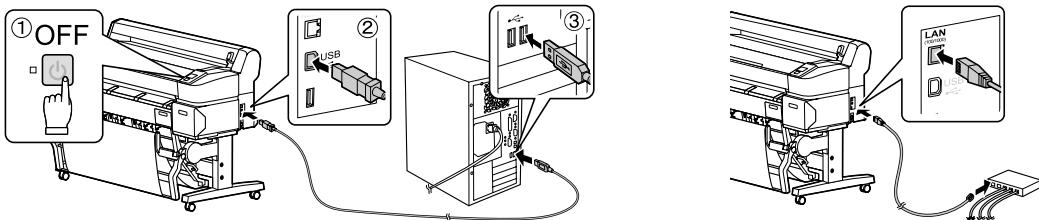
2. Conecte el otro extremo del cable al puerto correcto de la computadora o del comutador o concentrador de red.
