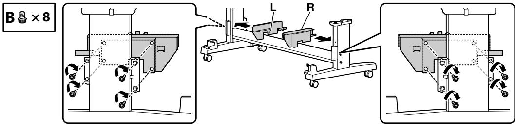
3. Retire la cinta adhesiva de las placas de montaje y extienda las barras deslizantes derecha e izquierda hasta escuchar un clic.
