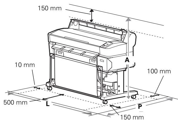
Ao escolher um local para a impressora, deixe um espaço adequado para o fácil acesso e a ventilação. Evite locais sujeitos a luz solar direta, calor excessivo, umidade ou poeira. Certifique-se de que a impressora seja colocada em um local plano e estável, que possa suportar o seguinte peso para cada impressora:
