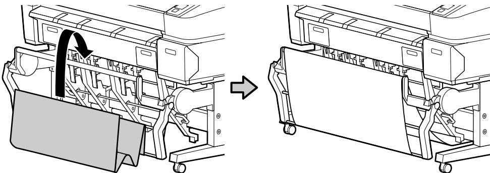
19. Desde la parte posterior de la impresora, estire la tela del cesto hacia arriba para que las guías de apilamiento se enganchen en las ranuras, tal como se muestra. Enganche los lazos en las clavijas posteriores de las guías de apilamiento para mantener el cesto fijo en su lugar.
