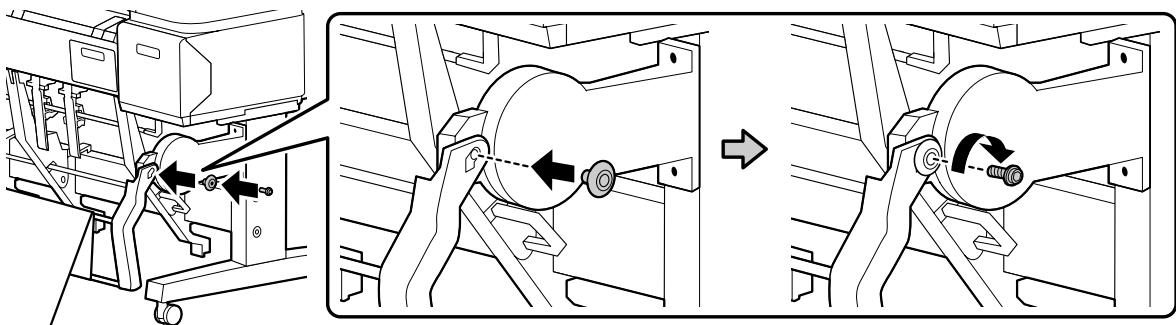
13. Instale el brazo más corto en el costado interior del soporte del cesto, en el lado izquierdo de la impresora. Use dos tuercas para mantener fijo el brazo.
