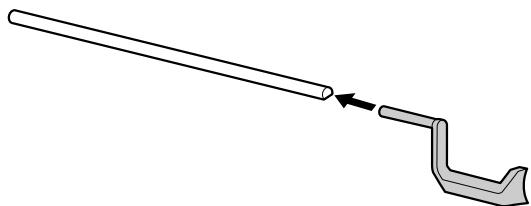
16. Introduzca el extremo de la varilla redonda en el brazo del lado izquierdo de la impresora. Después, alinee el brazo derecho con los agujeros de montaje del soporte derecho del cesto.
