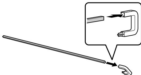
3. Deslice la varilla por los agujeros de los estabilizadores y fije el conector de plástico al soporte de la impresora. Luego, anexe otro conector de plástico a la varilla y al soporte de la impresora.
