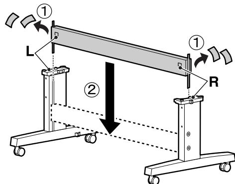
3. Apriete los tornillos preinstalados en cada costado del montante horizontal con el extremo largo de la llave hexagonal (Allen).
