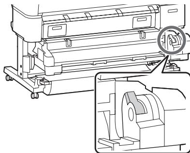
5. Coloque os adaptadores do rolo de papel nas guias de adaptador, com o lado plano voltado para baixo. Depois, deslize o papel em rolo para dentro cuidadosamente.
