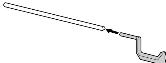
16. Insira a extremidade da barra arredondada no braço do lado esquerdo da impressora. Depois, alinhe o braço direito da cesta com os orifícios de montagem no suporte direito da cesta.
