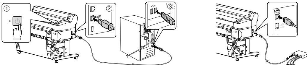
2. Conecte a outra extremidade do cabo à porta adequada em seu computador, chave de rede ou hub.
