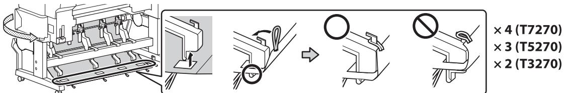
20. Enganche los lazos laterales del cesto en las clavijas localizadas en la parte posterior de las patas del soporte de la impresora para fijar el cesto a la impresora.
