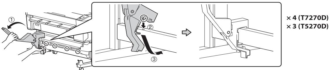
2. Remova os parafusos da frente da base da impressora e depois abra as coberturas do trilho.
