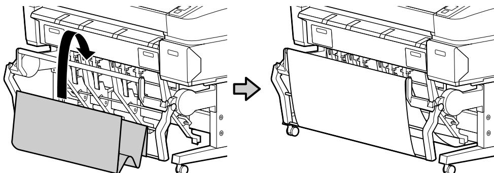
19. Na parte traseira da impressora, levante a cesta para que as guias da pilha se encaixem nas aberturas, conforme mostrado. Em seguida, coloque os laços em torno dos pinos na parte traseira das guias da pilha para prender a cesta no lugar.
