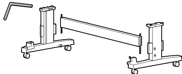
2. Instale el montante horizontal en las patas del soporte, tal como se muestra a continuación.
