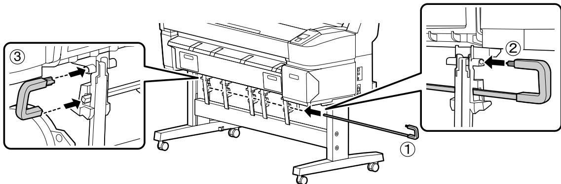
4. Instale las guías de apilamiento a la parte inferior de la impresora. Confirme de que cada guía se encaje bien en su lugar.
