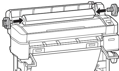
7. Baje la palanca de bloqueo de los adaptadores para fijarlos.
