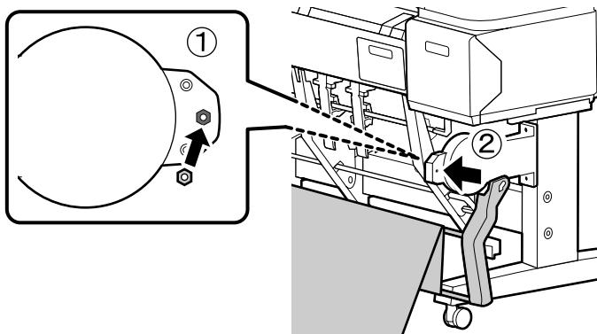
12. Insira o protetor de parafuso pelo braço da cesta e no orifício de parafuso. Insira o parafuso no protetor e aperte-o. Repita os passos 11 e 12 no lado esquerdo da impressora.
