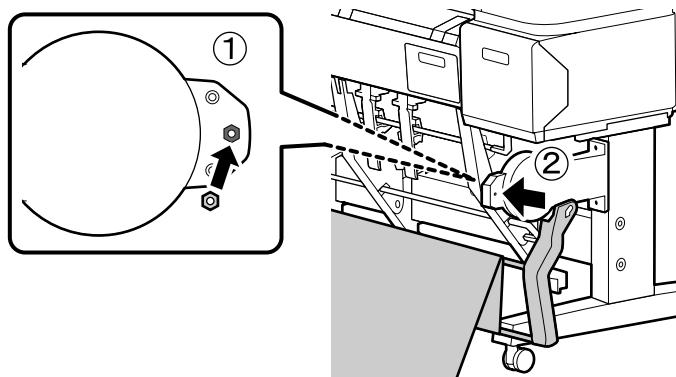
12. Introduzca un taquete expansor en el brazo del cesto y en el agujero para el perno. Luego introduzca el perno en el taquete expansor y ajústelo. Repita los pasos 11 y 12 en el lado izquierdo de la impresora.
