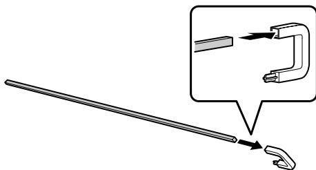
3. Deslize a barra através dos orifícios nos estabilizadores e anexe um conector plástico à outra extremidade da barra. Em seguida, fixe os conectores plásticos no lugar, em cada lado do suporte.
