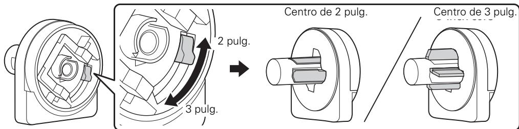
5. Desbloquee la palanca de bloqueo de ambos adaptadores.
