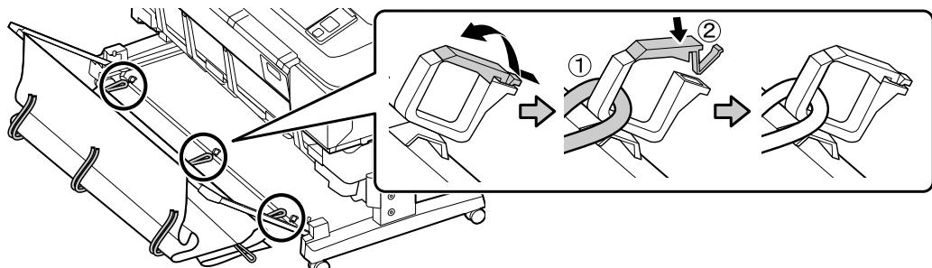
7. Enganche los lazos laterales de la parte inferior del cesto en las clavijas del soporte de la impresora.
