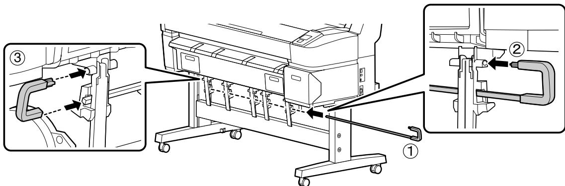
4. Anexe as guias da pilha na parte inferior da impressora. Certifique-se de que cada guia se encaixe de maneira segura no local.
