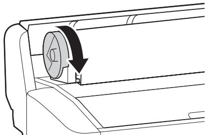
12. Baje la palanca de bloqueo del rollo.
