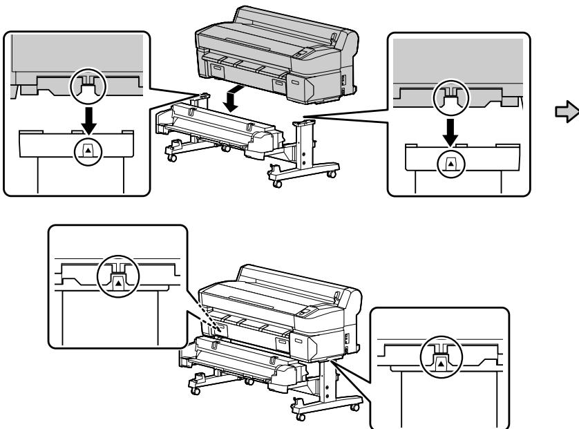
2. Conecte a impressora ao suporte usando três parafusos.
