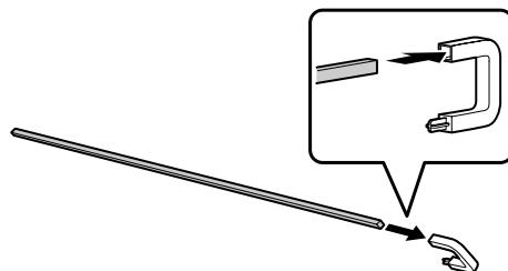
6. Deslice la varilla por los agujeros de las guías de apilamiento y fije el conector de plástico al soporte de la impresora. Luego, anexe otro conector de plástico a la varilla y al soporte de la impresora, tal como se muestra.
