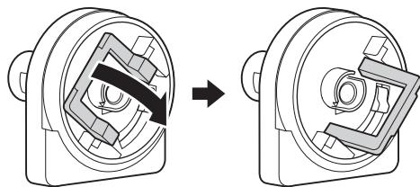
6. Coloque un adaptador en cada extremo del rollo de papel. Presione los adaptadores hacia adentro hasta que se encajen por completo en el centro del rollo.
