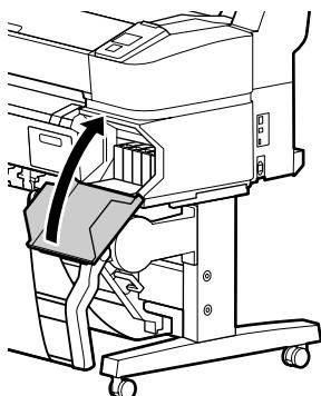
**Cuidado:** Não desligue a impressora ou abra qualquer tampa quando a tinta estiver carregando, ou você poderá desperdiçar tinta. Quando o carregamento de tinta estiver concluído, pressione e uma mensagem pedindo que coloque papel será exibida no painel de controle. Não realize operações diferentes das especificadas na tela.
