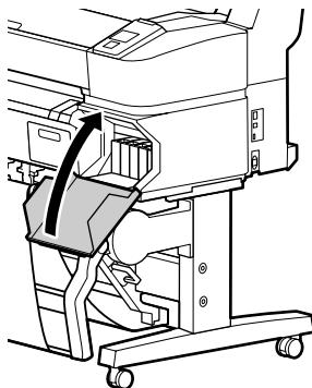
**Precaución:** No apague la impresora o abra la cubierta del compartimento de cartuchos mientras la tinta se esté cargando, de lo contrario, es posible que desperdicie tinta. Cuando la carga de tinta haya finalizado, pulse el botón . Aparece un mensaje en el panel de control indicándole que cargue el papel. Solamente realice las operaciones que se indican en la pantalla.
