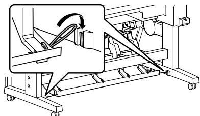
21. Deslice la tela del cesto hasta el extremo derecho de la barra por la parte frontal de la impresora.
