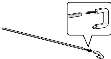
6. Deslize a barra através dos orifícios nas guias da pilha e anexe um conector plástico à outra extremidade da barra. Em seguida, fixe os conectores plásticos no lugar, em cada lado do suporte.
