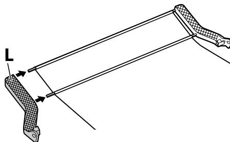
10. Fije los soportes del cesto, uno en cada lado del soporte de la impresora. Utilice cuatro pernos para fijar los soportes del cesto.
