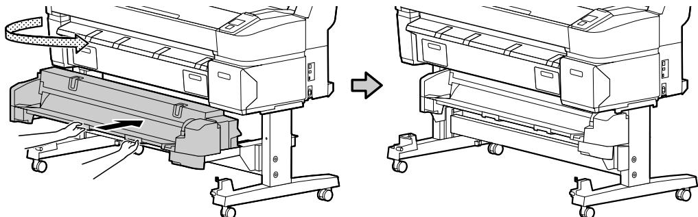
4. Instale la guía para cables en la parte posterior de la unidad de rollo adicional.
