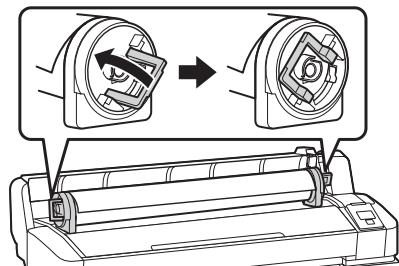
8. Deslice el rollo de papel a la extrema derecha, hasta que quede alineado con las guías del adaptador.
