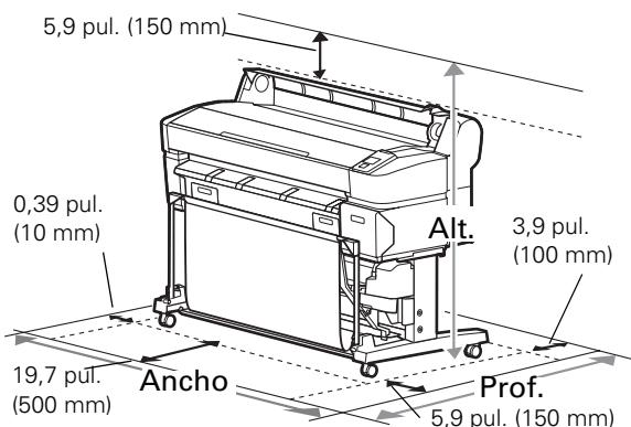
Seleccione un lugar donde haya suficiente espacio para acceder fácilmente al equipo y una ventilación adecuada. Evite lugares que estén expuestos a luz solar directa, calor excesivo, humedad o polvo. Coloque la impresora en un lugar plano y estable que pueda soportar el peso de la impresora.
