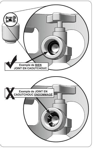
Fig. 10-1 Inspecter le joint en caoutchouc
