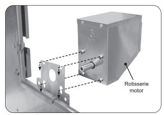
Fig. 42-2 Install rotisserie motor
