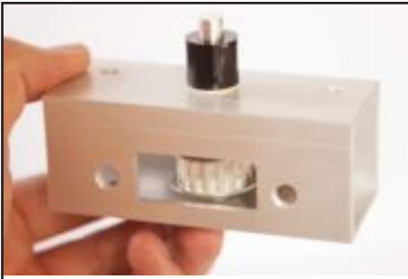
31. Insert Handle Spacer (10.) over Shaft.
