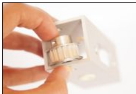
8. Insert Small Pulley (5.) inside Pulley Box (1.).
