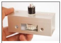
31. Insert Handle Spacer (10.) over Shaft.
