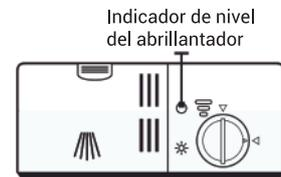
Si el depósito del abrillantador está lleno, el indicador estará totalmente oscuro. El tamaño del punto oscuro se irá reduciendo a medida que disminuye la cantidad de abrillantador. No debe dejar que el nivel del abrillantador caiga por debajo de 1/4. Al disminuir el nivel, el tamaño del punto oscuro en el indicador de nivel del abrillantador cambiará, como se ilustra a continuación.
