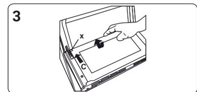
1. Empuje el cristal en la dirección de **B** y libérelo del soporte de colocación (**x**). Extraiga el cristal en la dirección de **A**.
