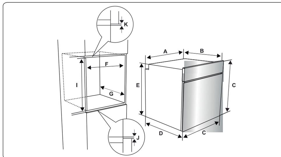
Una vez que se hayan realizado las conexiones eléctricas, inserte el horno en el armario empujándolo hacia delante. Abra la puerta del horno e inserte 2 tornillos en los orificios que se encuentran en el bastidor del horno. Con el marco del producto tocando la superficie de madera del armario, apriete los tornillos.
