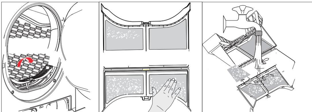
¡Importante! No utilizar la secadora sin el filtro de pelusas instalado.
