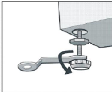
Notas: En principio, solamente hay una pata suelta. Si esta pata se encuentra en la parte posterior de la secadora ajustarla resulta complicado, ajuste otra pata en su posición diagonal para obtener el mismo efecto.
