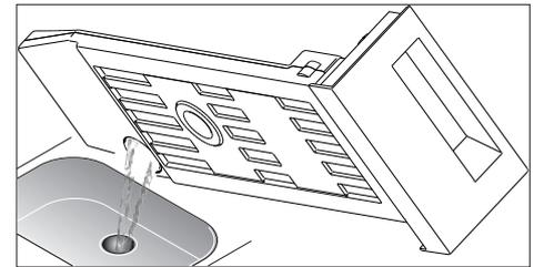
¡Importante! No utilizar la secadora sin el depósito de agua instalado.
