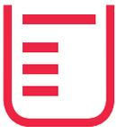
Cuando parpadee este símbolo debe vaciar el depósito de agua. Debe hacerlo cada vez que use la secadora una vez finalizado el programa de secado.
