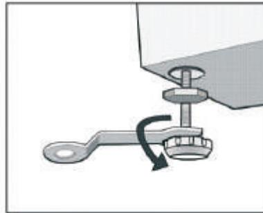
Notas: En principio, solamente hay una pata suelta. Si esta pata se encuentra en la parte posterior de la lavadora ajustarla resulta complicado, ajuste otra pata en su posición diagonal para obtener el mismo efecto.
