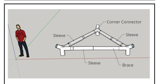
SLIDE A SLEEVE OVER ONE BRACING TUBE FROM EACH CORNER CONNECTOR.
