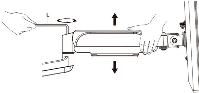
Ajustar la tensión del brazo, una vez instalado el monitor, de la siguiente manera:
