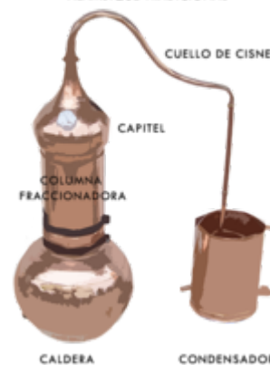
DESTILACIÓN FRACCIONADA ALAMBIQUE TRADICIONAL
