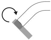
1 Envuelva la cinta de teflón en dirección a las manecillas del reloj de manera ajustada alrededor de la tubería. La cinta se estirará. Esto está bien y es deseado. Al envolver la cinta se crea un sello sólido para prevenir goteos.
