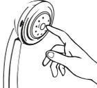
Para remover los depósitos minerales, simplemente deslice su dedo a través de las puntas de las boquillas mientras la regadera esté funcionando.
