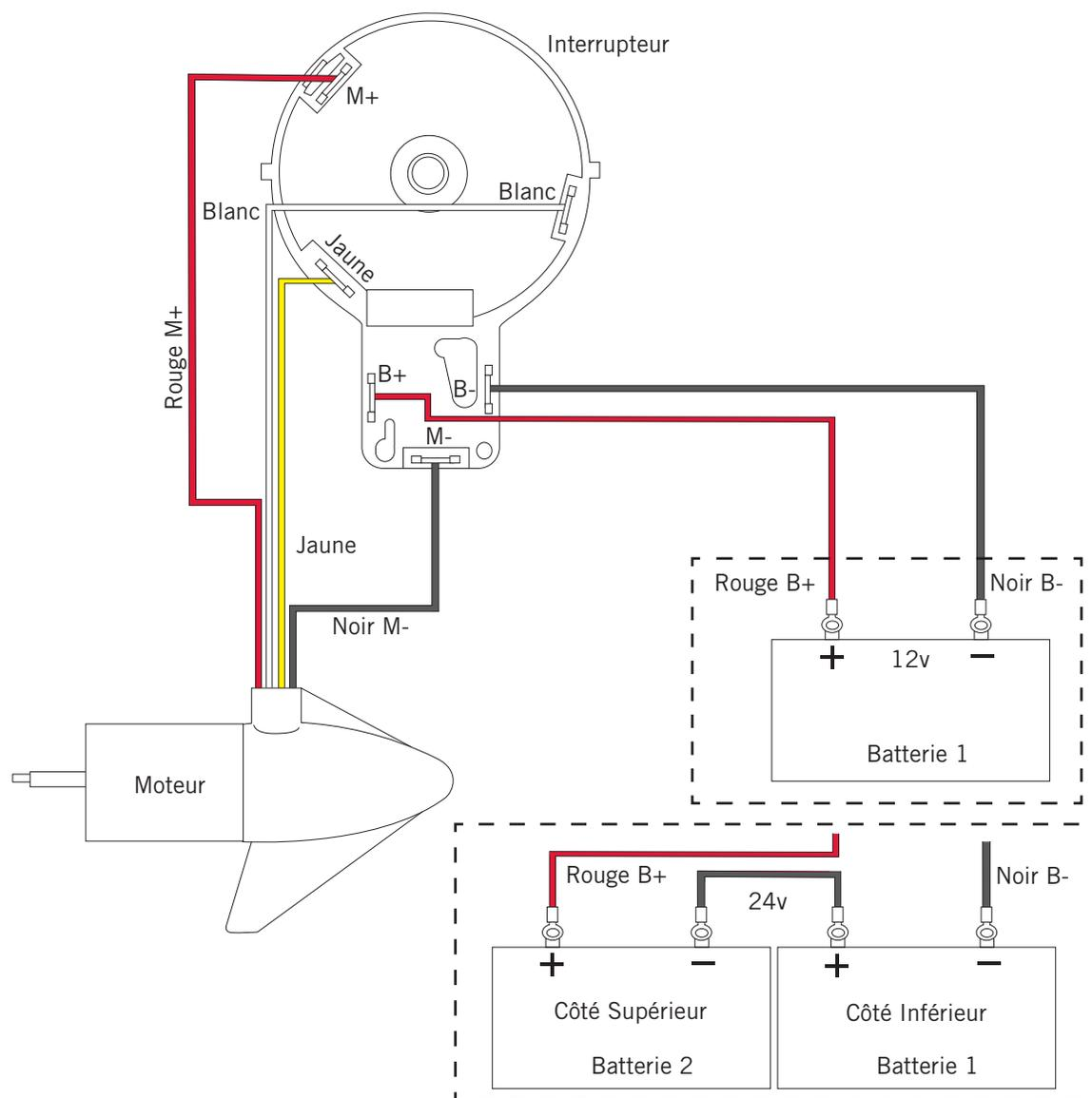
**AVIS :** Il s'agit d'un schéma multitenion. Revérifiez la tension de votre moteur afin d'effectuer les raccordements appropriés. Les dispositifs de protection contre la surintensité ne figurent pas dans cette illustration.
