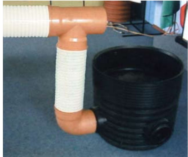
FIGURA 9.4 CONEXIÓN A POZO DE VISITA PLÁSTICO
