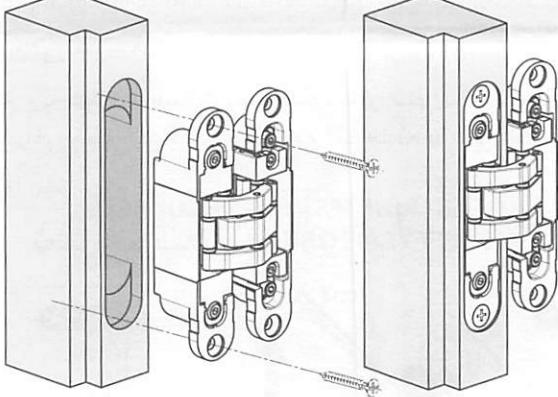
**IT** - Inserire la parte delle cerniere marchiata **"door"** (profondità 30 mm) nelle fresate dell'anta avendo cura di scegliere il corretto verso di apertura, fissare quindi le cerniere avvitando le appropriate viti da legno.
