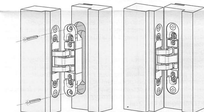
**IT** - Montare l'anta sullo stipite inserendo la parte telaio delle cerniere (profondità 21 mm) nelle apposite fresate, fissare quindi le cerniere avvitando le appropriate viti da legno.
