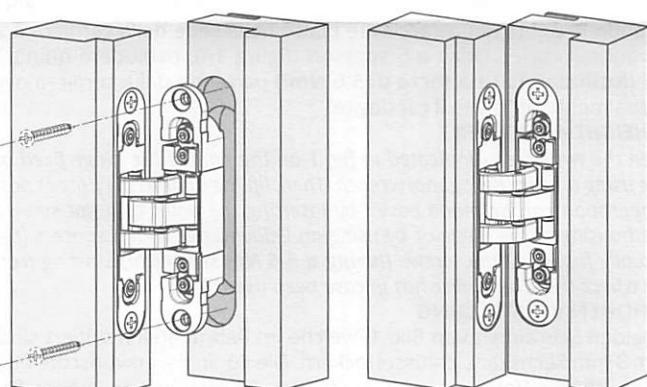
**ES** - Monte la puerta sobre el pilar, introduciendo la parte marco de las bisagras (profundidad 21 mm) en las ranuras correspondientes, luego fíjelas enroscando los tornillos específicos.
