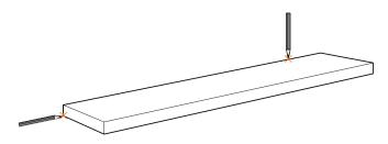
USE A LEVEL TO MARK THE LOCATION OF THE INNER METAL BRACKET.
