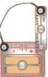
3. **Les connections a Boutons-Pression:** Utilisez ce mini-circuit pour tester une a une les connections a Boutons-Pression. La lampe devrait s'allumer.
