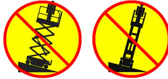
不能把倾斜警报器当成水平指示器。只有机器严重倾斜时，底盘及平台的倾斜警报器才会鸣响。如果倾斜警报器鸣响：
