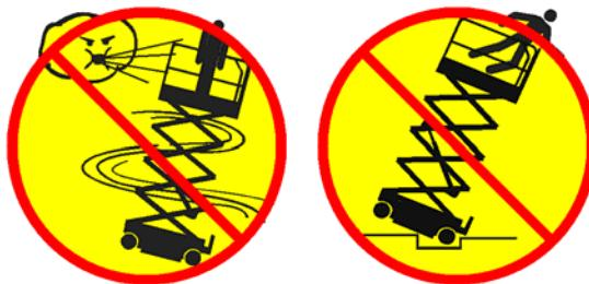
强风或阵风时不能操作机器。不能增加平台或负载的表面面积。加大暴露在风中的面积将降低机器的稳定性。
