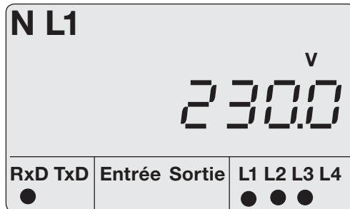
Fig. Exemple d'affichage "mode d'affichage". Valeur mesurée affichée : U_{L1-N} = 230,0 V.
