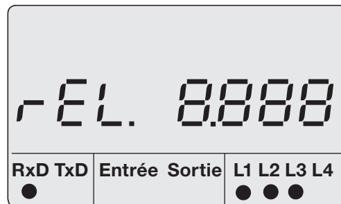
Fig. Affichage des valeurs mesurées avec version de firmware.
