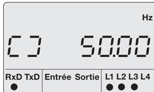
Fig. Exemple d'affichage pour le champ magnétique rotatif et la fréquence.
