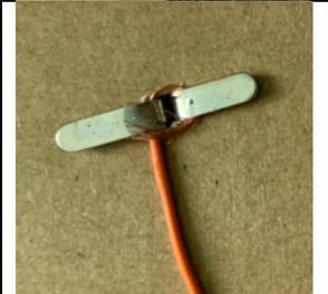
Im nächsten Schritt habe ich das andere Ende des Klingeldrahts ebenfalls abisoliert mit leitfähigem Klebeband umklebt und dieses dann mit Klebeband fixiert.
