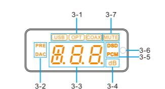
3-1 输入通道指示（若当前输入连接成功，当前输入的指示灯常亮，反之则指示灯闪烁）
