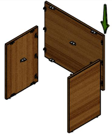
Colocar la base y la repisa a los laterales ensamblando con los ganchos macho/hembra y sujetar con regatón de pellizco 2
