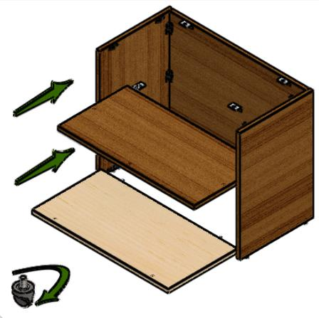
Colocar cubierta ensamblado con ganchos macho/hembra y sujetar con regatón de pellizco 12mm al fondo 3
