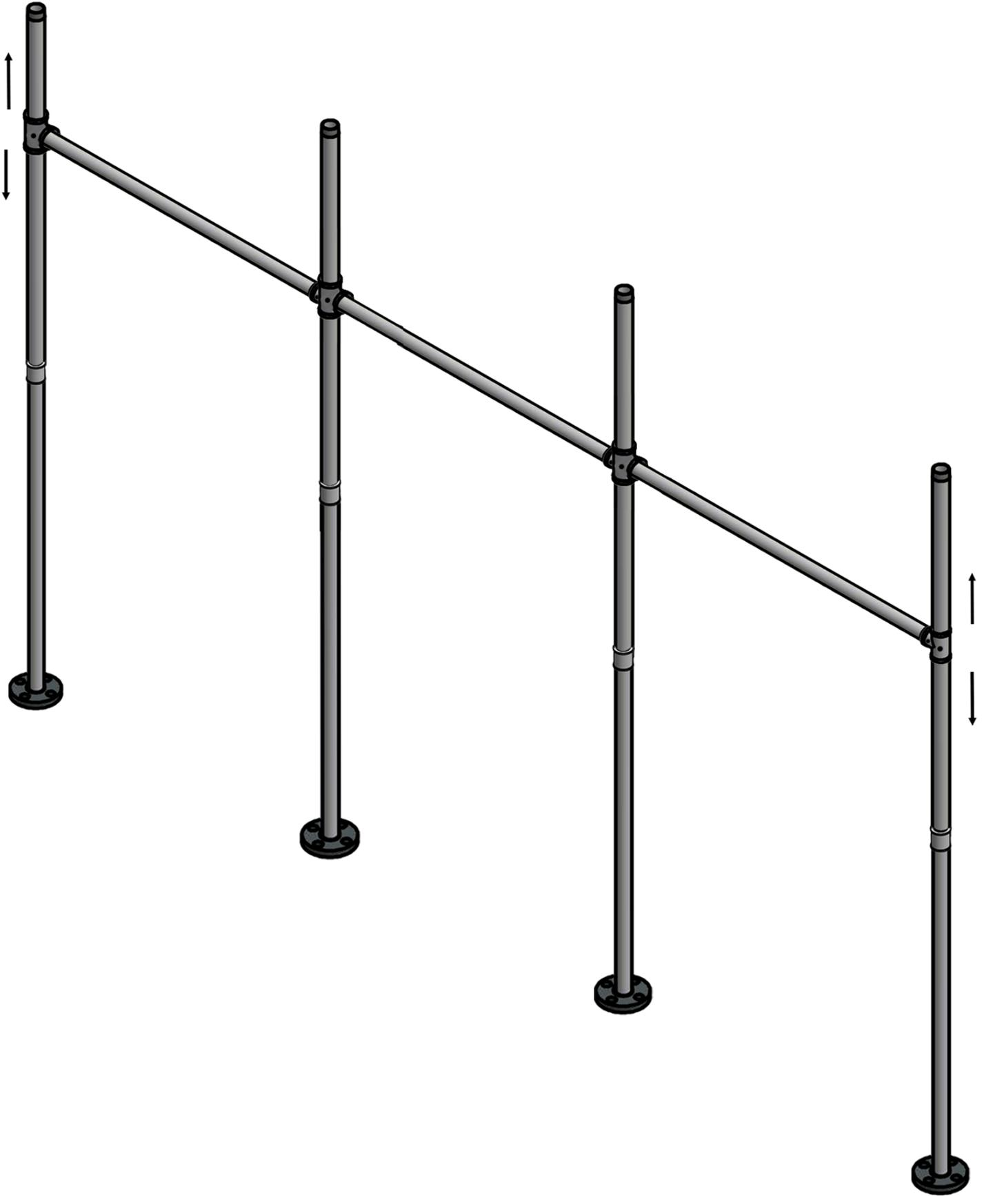
Befestige die Querstange mithilfe des Imbusschlüssels auf der gewünschten Höhe
