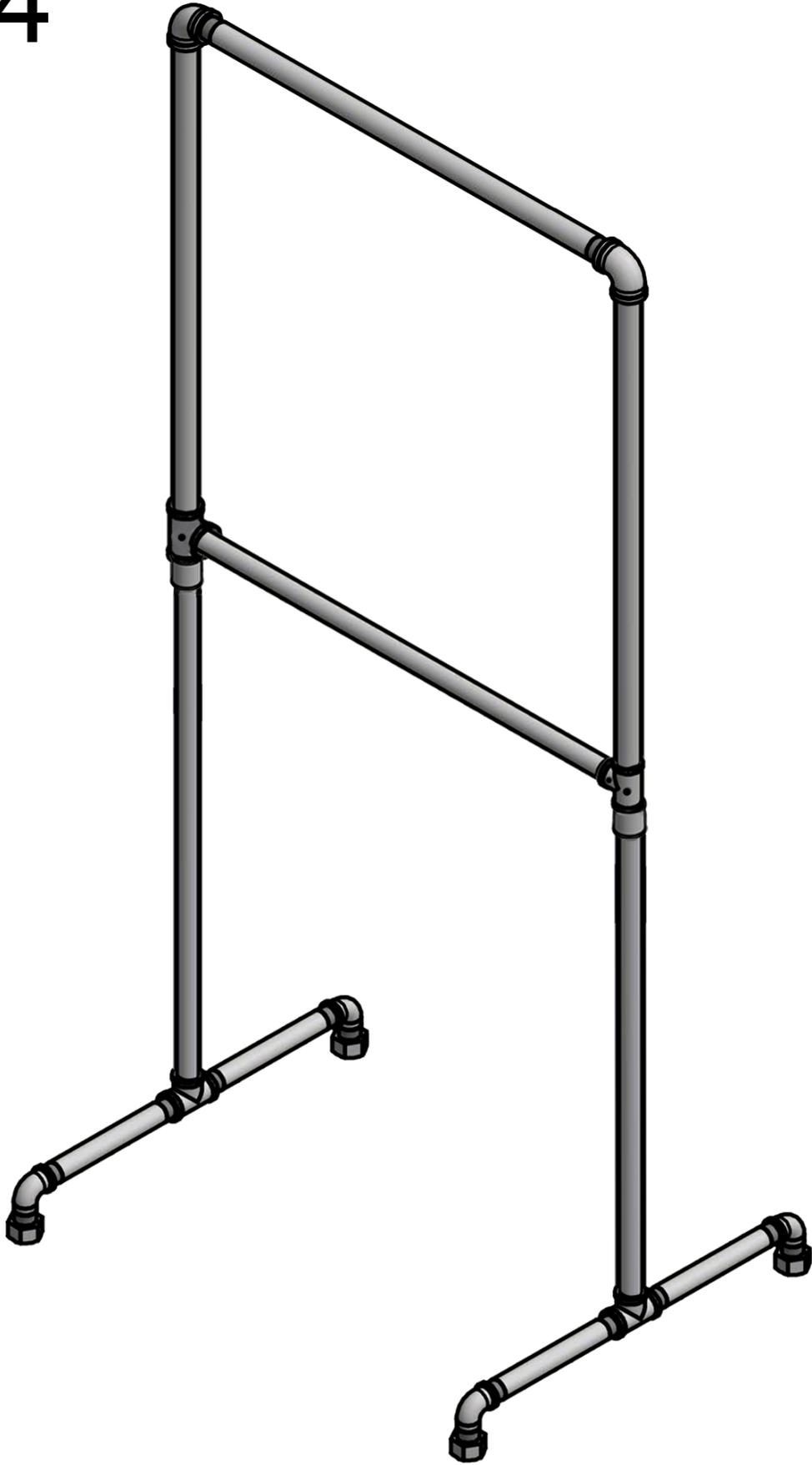
**Befestige die Querstange mithilfe des Imbusschlüssels auf der gewünschten Höhe**
