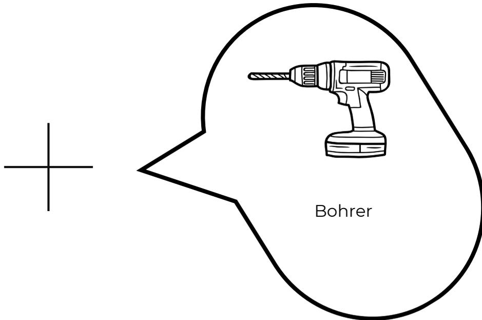
Abhängig von der Wand werden unterschiedliche Bohrer benötigt. Eventuell werden auch andere Schrauben & Dübel benötigt. Die mitgelieferten Dübel & Schrauben sind für eine normale Ziegelwand ausgelegt.
