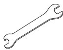
Clé plate 13 mm (pour M8 et M6) x 6 mm (pour arbre hexagonal)
