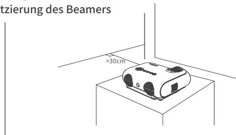
Bitte lassen Sie mindestens 30 cm Abstand zu den Wänden, um eine ausreichende Belüftung zu gewährleisten und die Leistung und Zuverlässigkeit des Projektors zu gewährleisten.
