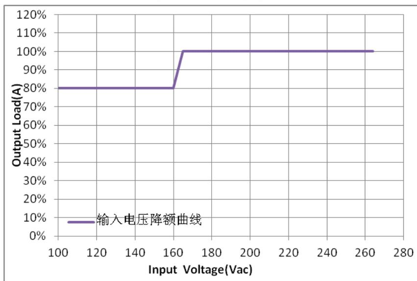
注：此曲线图为测试时，电源模块机壳紧贴一块 320mm\*320mm\*22mm 散热板的带负载曲线；
