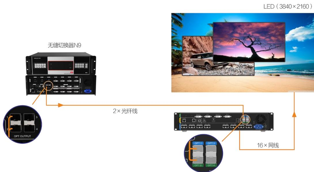
使用时，可直接在窗口的“输入源”列表中选择相应的 OPT 输入源。
