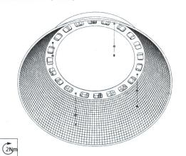
移除尼龙螺丝,用反射器附带的螺丝和垫片固定反射器。
