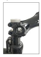
Prüfung ob das Steuerrohr konifiziert ist. Ist das Tool komplett versenkbar, passt alles!
