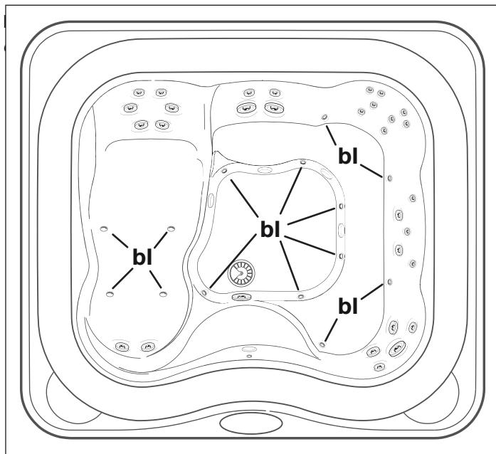
**NOTA:** se recuerda que todas las operaciones relativas a la introducción o sustitución del cartucho perfumado competen exclusivamente al gestor de la instalación. La sustitución de los cartuchos, una vez agotados, debe efectuarse con el blower apagado.
