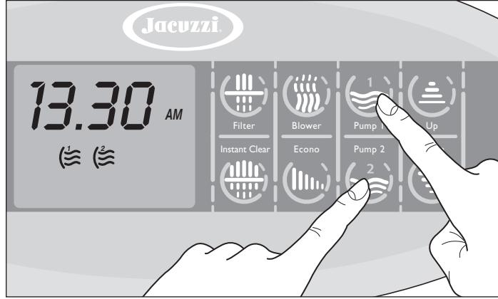
► Нажать клавишу “Pump 1” для подключения соответствующего насоса. Нажать клавишу “Pump 2” для подключения другого насоса.
