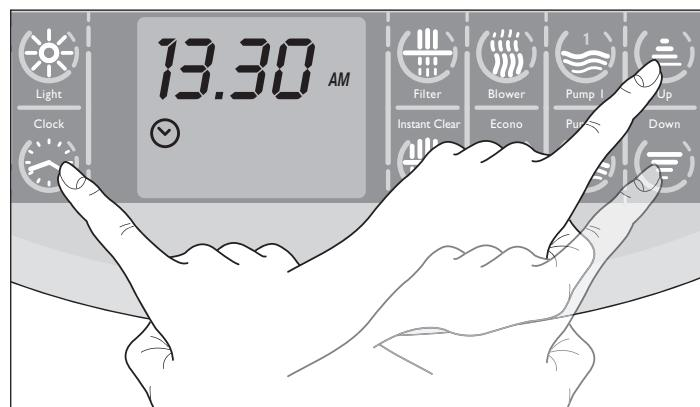
► Удерживать нажатой клавишу "Clock" ⏱ на протяжении приблизительно 5 секунд: будет отображено текущее время с мигающей цифрой часов, в то время как на дисплее появится соответствующий символ.
