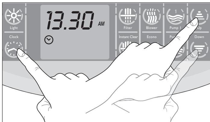
► Si l'on maintient la touche "**Clock**" (⌚) enfoncée pendant 5 secondes environ, l'heure apparaîtra avec le chiffre des heures qui clignote sur l'écran, avec le symbole correspondant.
