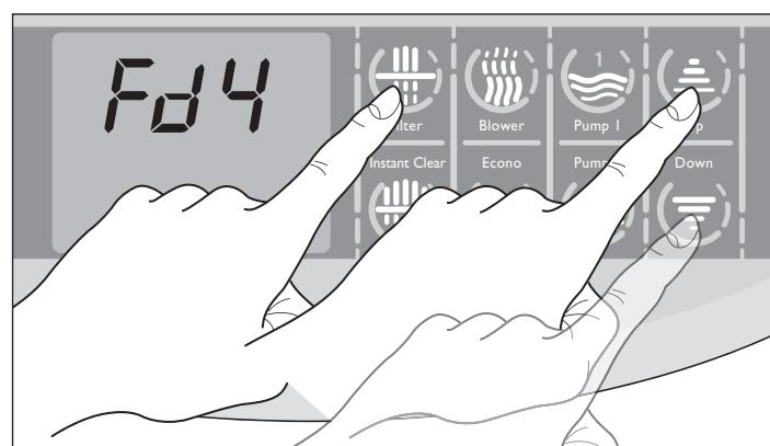
► Pulse el botón “Filter” (FilterWhere): la pantalla muestra el mensaje Fdx (donde “x” indica la duración en horas).
