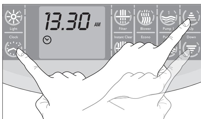
► Die Taste "**Clock**" ⏱ für ungefähr 5 Sekunden drücken: Es wird die aktuelle Uhrzeit angezeigt und die Stundenziffer blinks, auf dem Display ist das entsprechende Symbol zu sehen.
