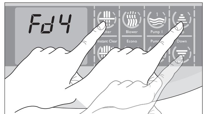
► Die Taste "**Filter**" ⏸ drücken: das Display zeigt die Schrift **Fdx** (wobei "x" die Dauer in Stunden anzeigt).
