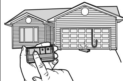
Si la puerta se detiene y no retrocede al hacer contacto con la obstrucción, aumente el recorrido (consulte el paso 1 de la sección Ajustes).
