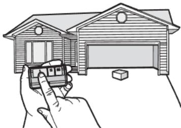
L'ouvre-porte de garage ne se fermera pas à partir d'une télécommande si le témoin lumineux de l'un ou l'autre des capteurs est éteint (ce qui vous avertit du fait que le capteur est mal aligné ou obstrué).
